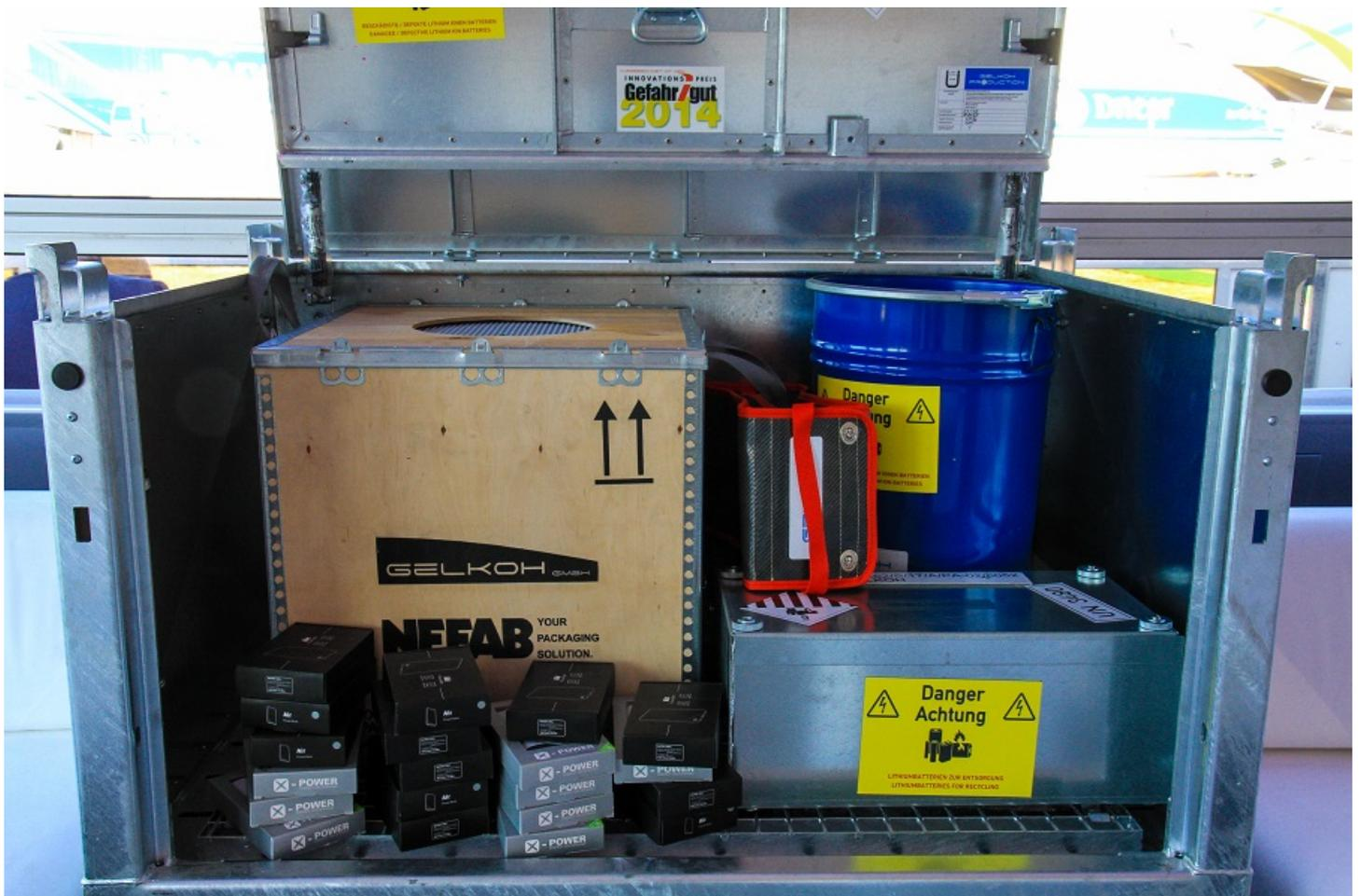
Прототип уникального контейнера, который был разработан авиакомпанией «ЭйрБриджКарго» и немецкой компанией Gelkoh, обладает необходимыми характеристиками для безопасной транспортировки литиевых батарей. Стенки контейнера выполнены из огнеупорного материала, а специальный материал на полу не позволяет огню разрушить паллету. Помимо этого, дым сможет выходить через отверстия в контейнере во избежание взрыва.
